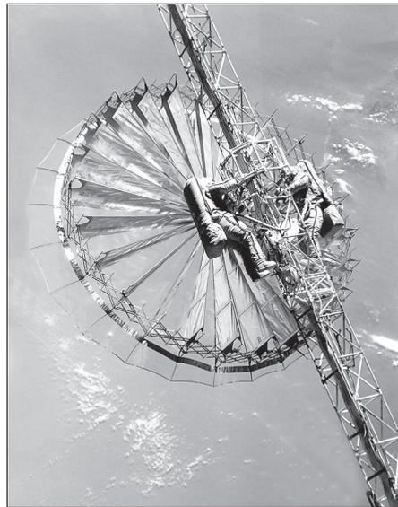
*В. Афанасьев и С. Авдеев в открытом космосе для разворачивания экспериментальной антенны «Рефлектор» на мачте «Софора». 28 июля 1999 г.*
